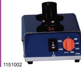
Zum Mischen von Flüssigkeiten in Reagenzgläsern bis Ø 30 mm, stufenlos einstellbar 0-2800 U/min, 230 V/50 Hz, Frequenz 0-45 Hz, 156 x 150 x 110 mm (L x B x H)
