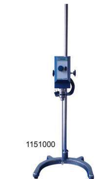
Rührmenge: 10 l, Motorleistung 83/75W, Drehzahlbereich 200 - 3.000 U/min., Gewicht 4,5 kg, 220V, 50/60Hz.
